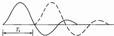
图 6-8 码间串扰示意图
