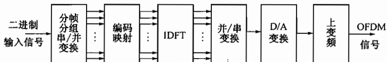
图 8-17 OFDM 调制原理方框图
