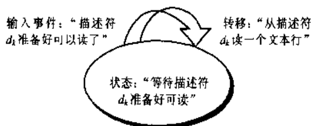
图 13.7 并发事件驱动 echo 服务器中逻辑流的状态机
