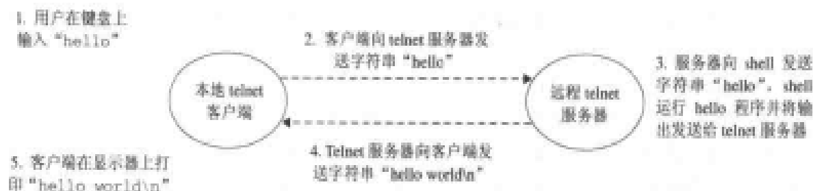
图 1.15 利用 telnet 跨越网络远程运行 hello
