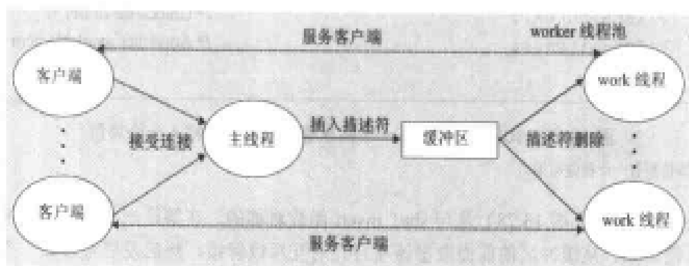
图 13.29 预线程化的并发服务器的组织结构
