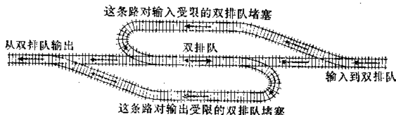
图 2 一个表示成铁路转轨网络的双排队
