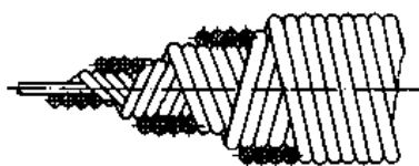
图 15-6 钢丝软轴的绕制
