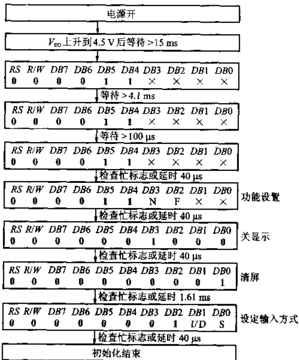
图 10-25 软件初始化流程
