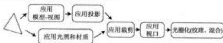
图 7-4 三角形的处理流程
