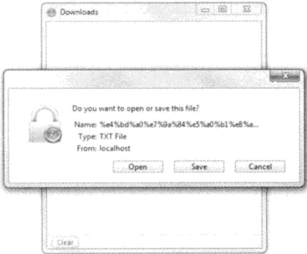
图 6-7 使用 Safari 下载由 ASP.NET MVC 下载中文文档名的对话框
