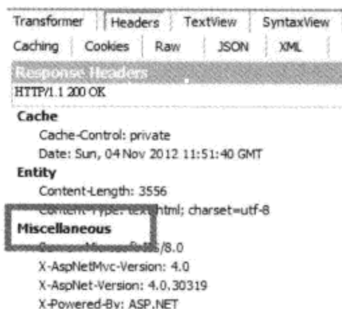
图 10-14 预设 ASP.NET MVC 会输出 X-AspNetMvc-Version 标头
