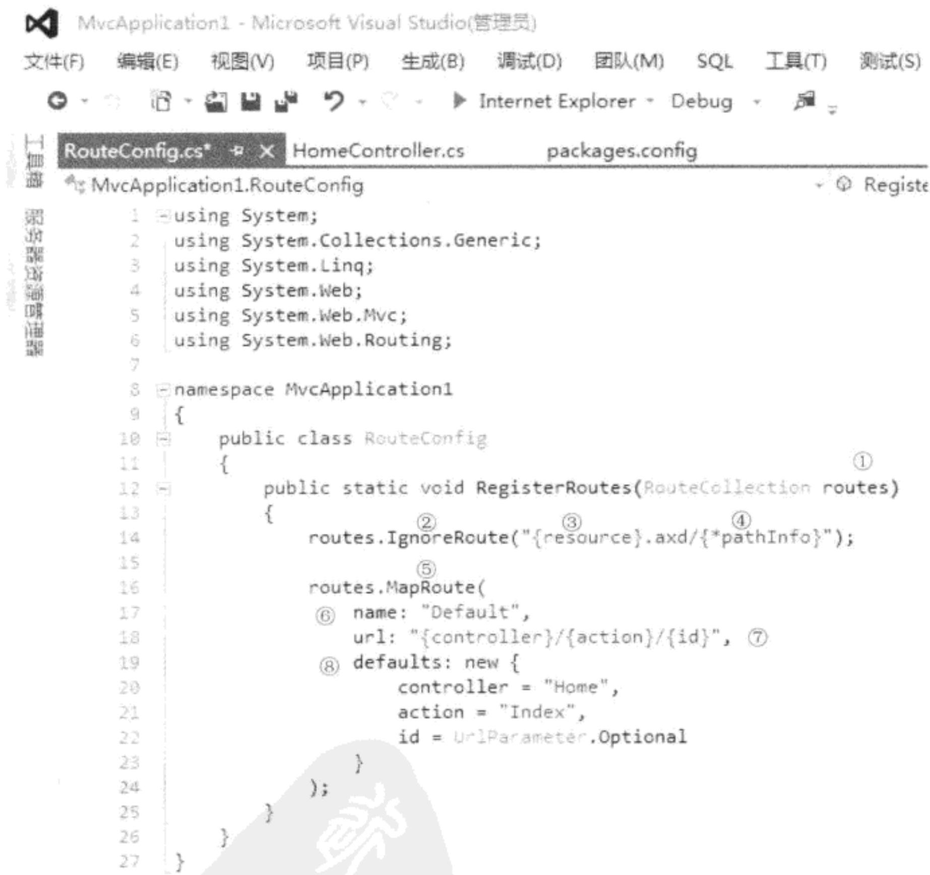
图 4-4 ASP.NET MVC 4 项目模板中默认的路由规则定义
