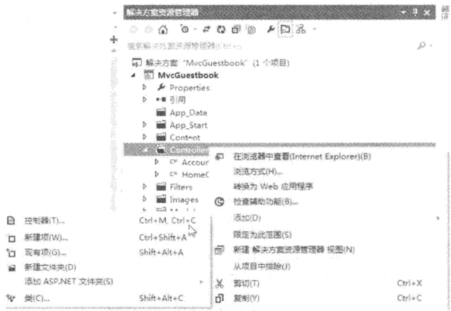
图 3-49 选择 Controllers 目录并添加控制器
