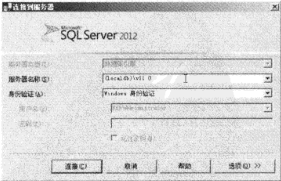
图 5-4 使用 Management Studio 连接 LocalDB 时应输入正确的服务器名称
