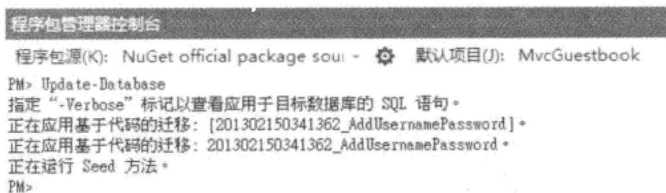
图 5-44 在程序包管理控制台窗格中运行 Update-Database 指令
