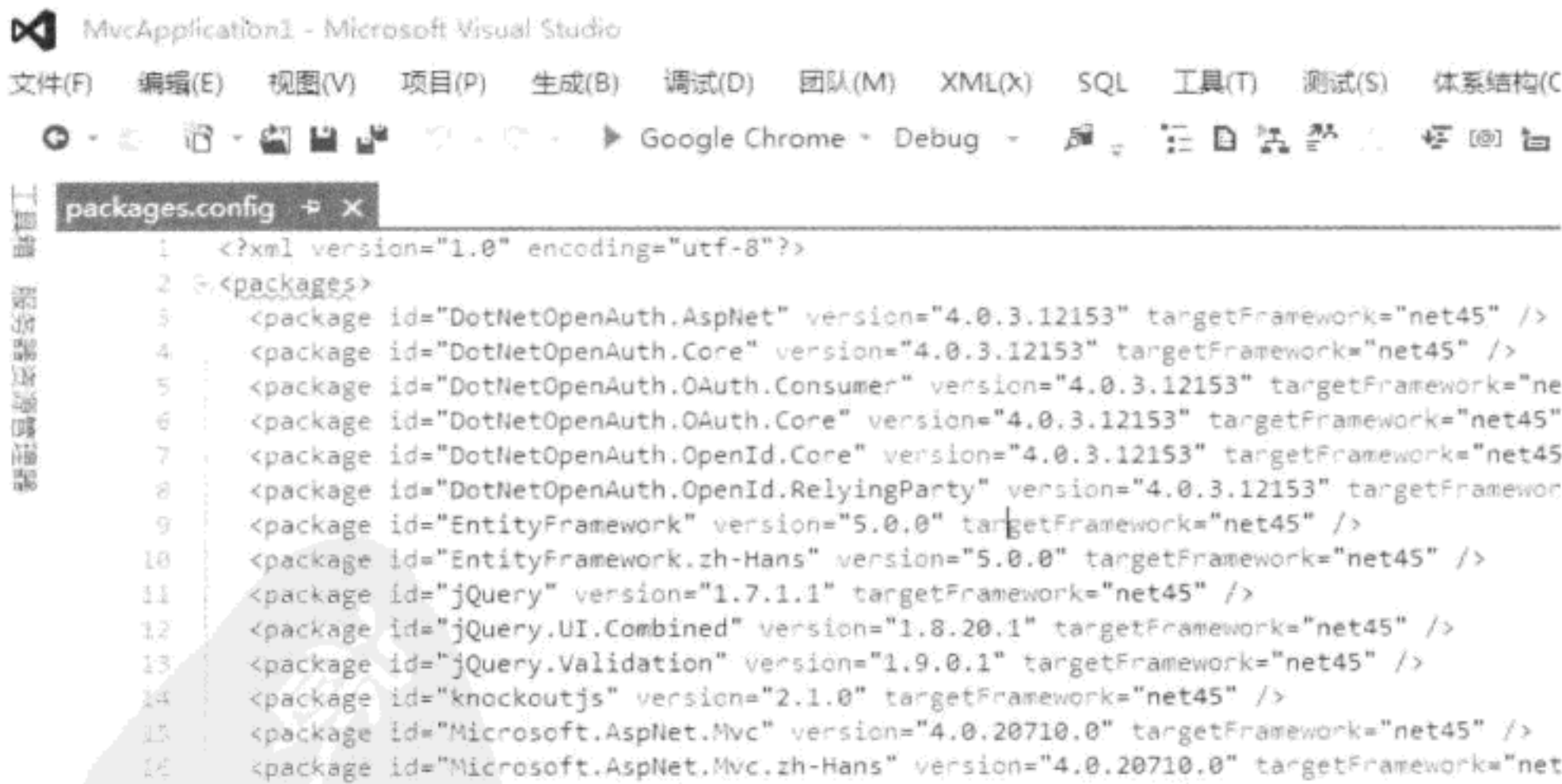
图 3-25 安装 NuGet 套件的 packages.config 文档属性
