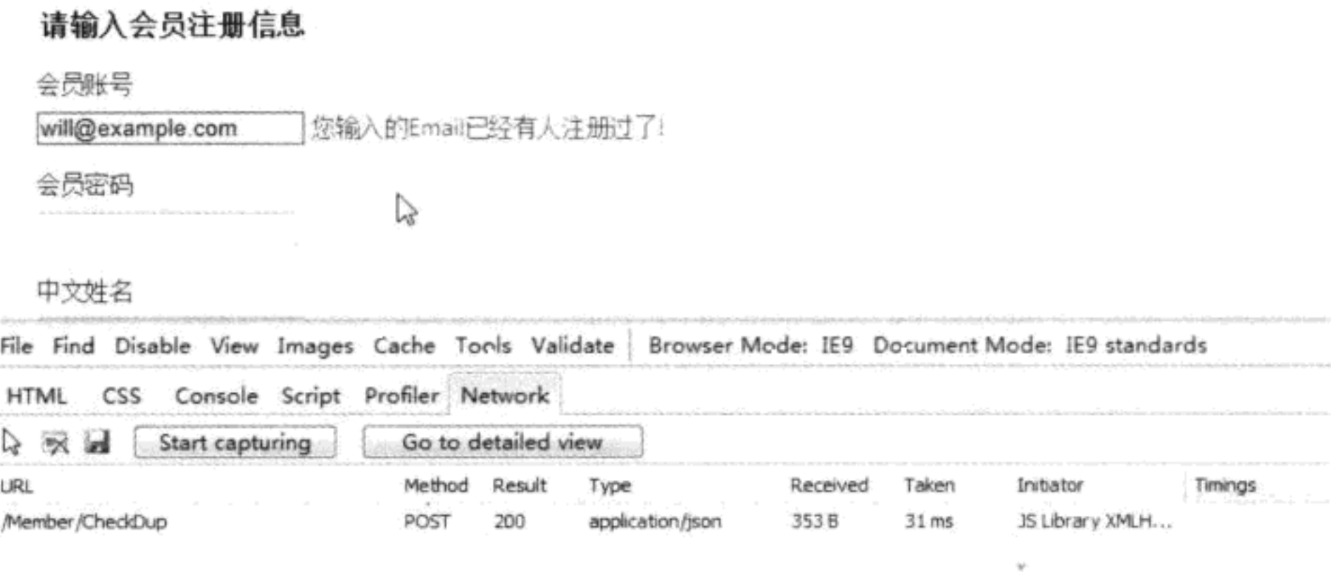
图 9-20 使用 ASP.NET MVC 提供的远程验证功能
