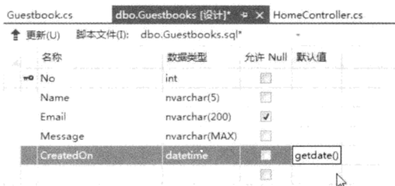
图 5-23 将数据库字段中的 CreatedOn 字段加上默认值 getdate()
