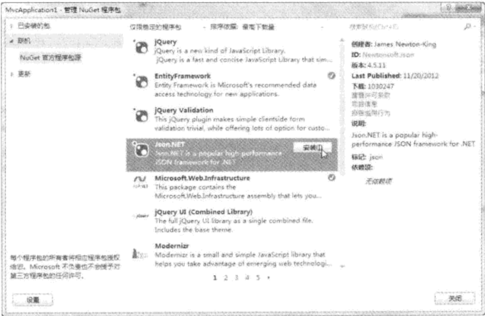
图 3-16 管理 NuGet 程序包，准备安装 Json.NET 套件
