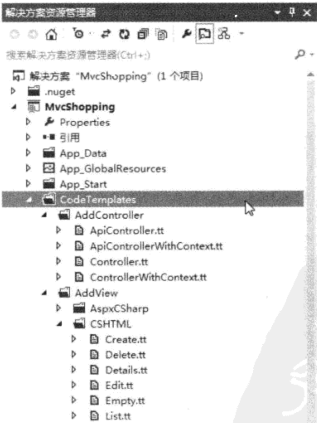
图 10-18 将 CodeTemplates 目录通过拖曳的方式拉进 ASP.NET MVC 专案根目录
