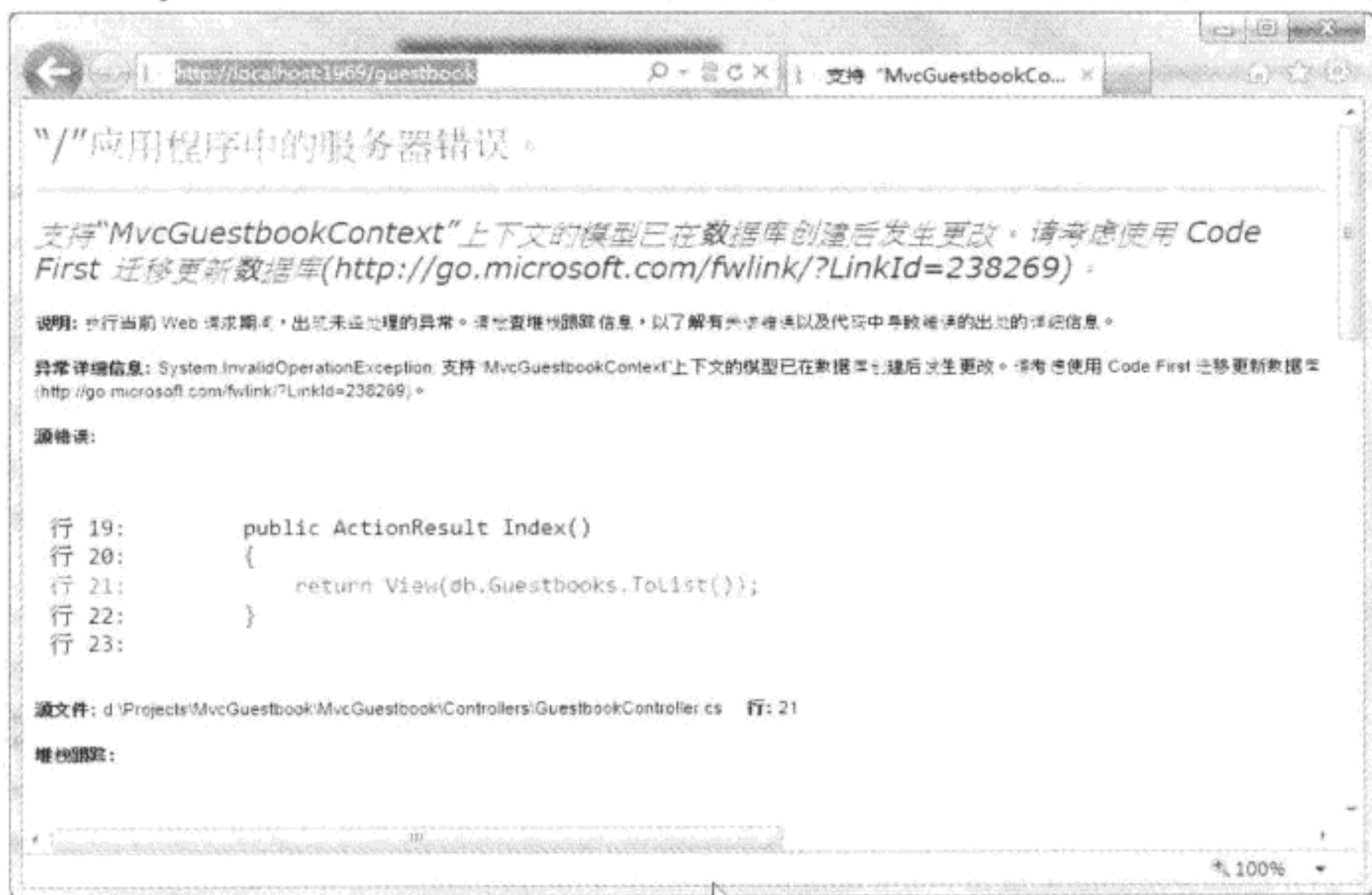
图 3-72 使用 EF Code First 时,当 Model 发生变更时默认会引发 System.InvalidOperationException 异常
