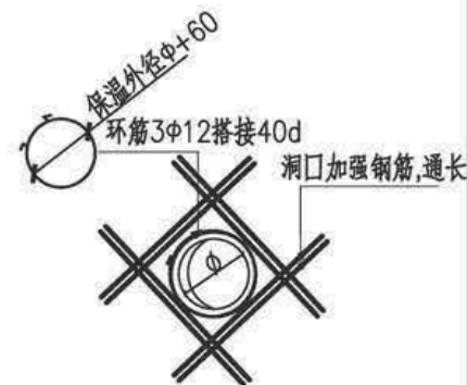
套袖洞口钢筋作法图 图中钢筋根数仅为示意
