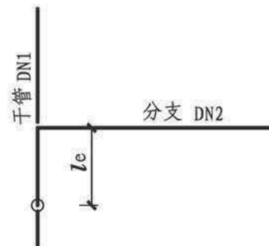
图4 在分支管上设置弯管补偿装置(平行分支)
