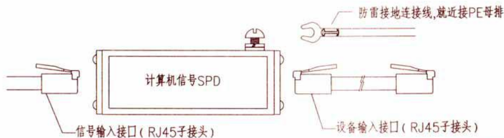
信号RJ45接口SPD安装示意图
