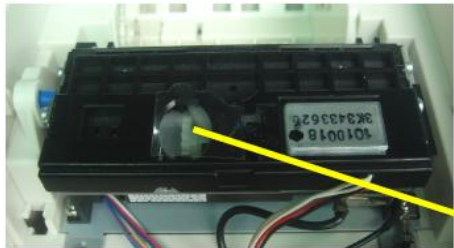
打开前盖后拨动切刀拨轮，使切刀收刀复位
