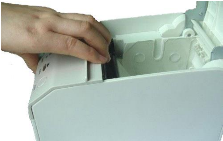
打开前盖后拨动切刀拨轮，使切刀收刀复位
